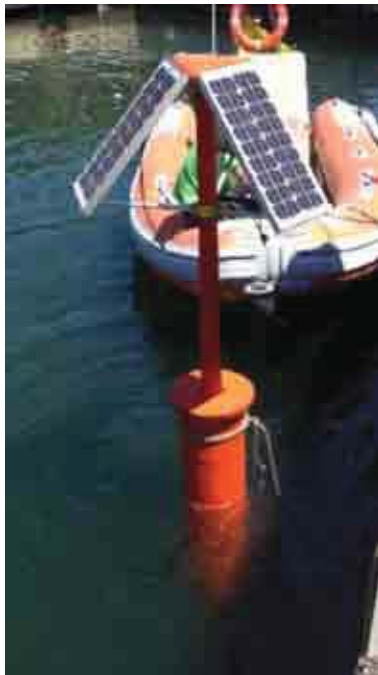
Fig. 1 La boa sensorizzata realizzata per l'acquisizione e la trasmissione dati The realized buoy equipped with sensors
