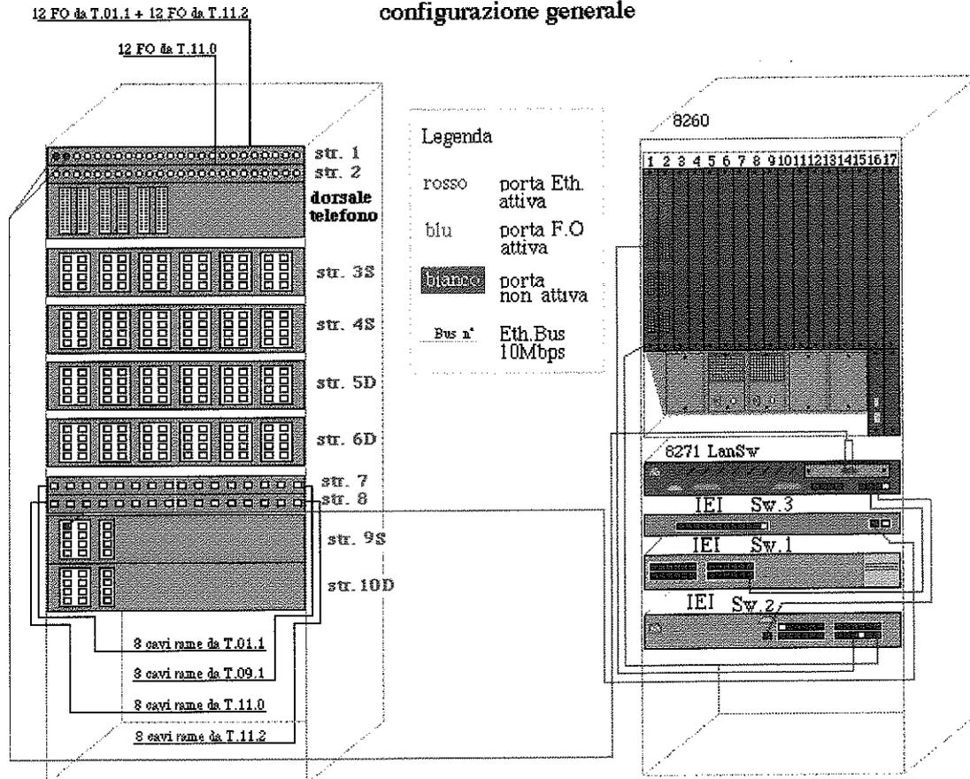
L'armadio T.11.1, è interamente dedicato alla sottorete IEI. In questo armadio sono disponibili 6 schede 8260-IBM a 12 porte eth. 10Mbps e tre "HUB-Switch", un 3Com 3300, un 8275-IBM (24 porte eth. 10/100Mbps) e un "Cisco Catalyst 1900" (12 porte eth. 10Mbps e 2 porte 10/100Mbps).
