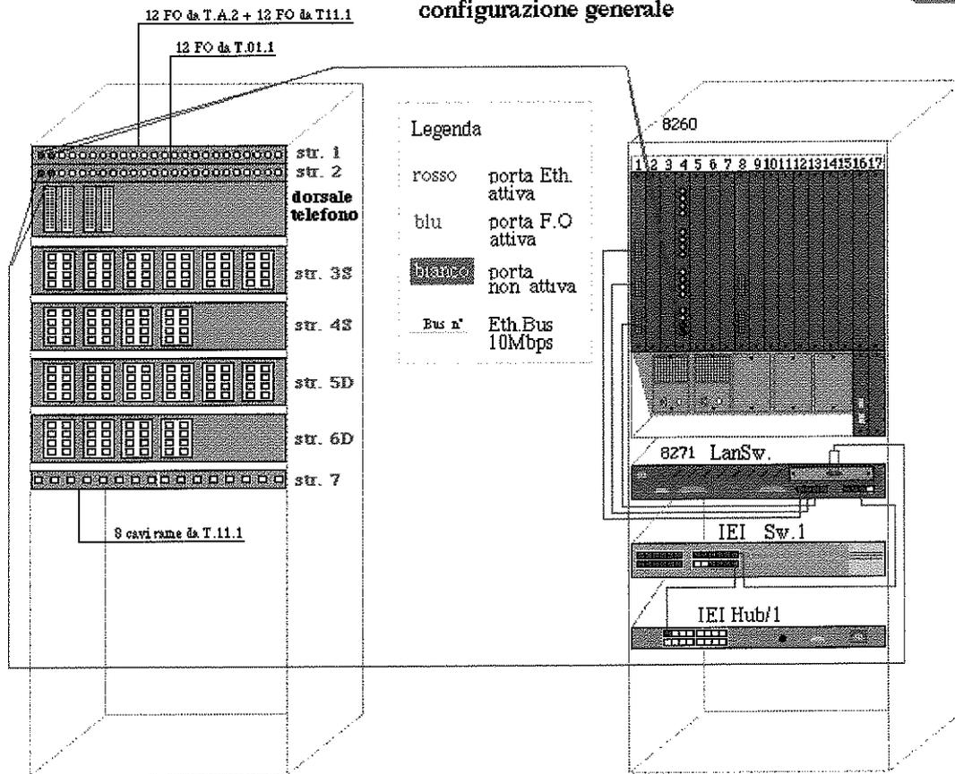
L'armadio T.11.2, è quasi interamente dedicato alla sottorete IEI. In questo armadio sono disponibili 6 schede 8260-IBM a 12 porte eth. 10Mbps, un "HUB-Switch", un 3Com 3300, un 8275-IBM (24 porte eth. 10/100Mbps) e HUB (16 porte eth. 10Mbps). Per la connessione al backbone ATM si utilizzano 7 porte dell' 8271-IBM nel seguente modo:
