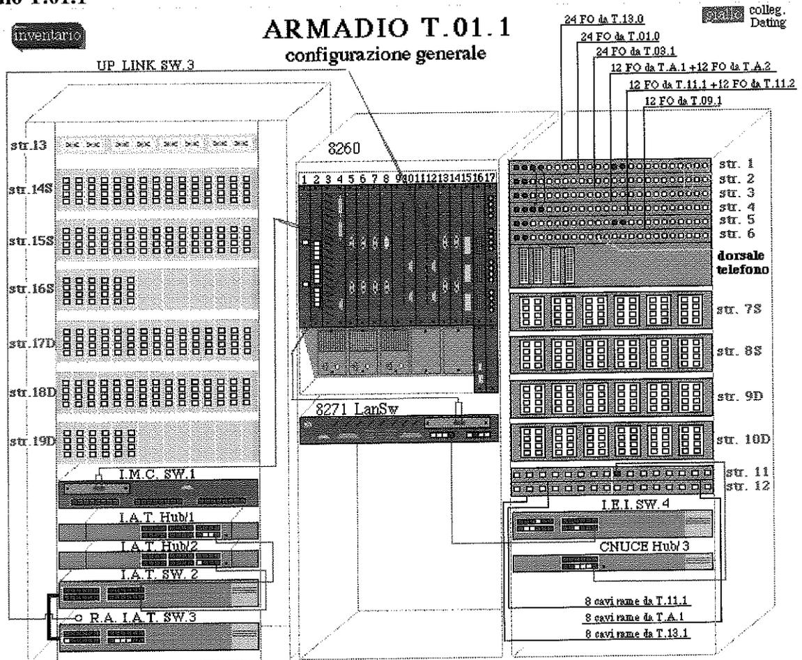
L'armadio T.01.1 come evidenziato nella figura qui sopra, ospita e gestisce più sottoreti. La sottorete IEI, concentra le sue connessioni periferiche sul "HUB-Switch" modello "3Com 3300" indicato come "I.E.I. SW.4" che è connesso al "LanSw IBM-8271" che a sua volta è connesso al backbone ATM.
