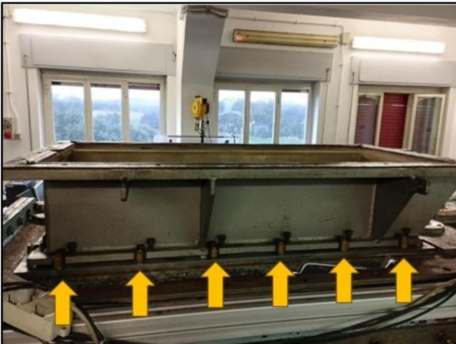
Serrare le viti di fissaggio intorno alla vasca di supporto.
