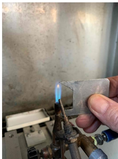
Figura 5. Altezza fiamma instabile con pressione a 640 mbar
