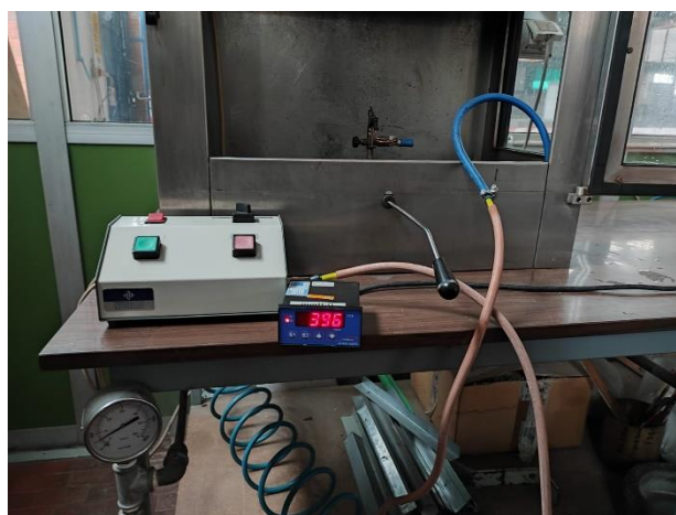
Figura 2. Apparecchiatura prova accendibilità strumentata con manometro analogico e manometro digitale Alpha Vuoto VCEA
