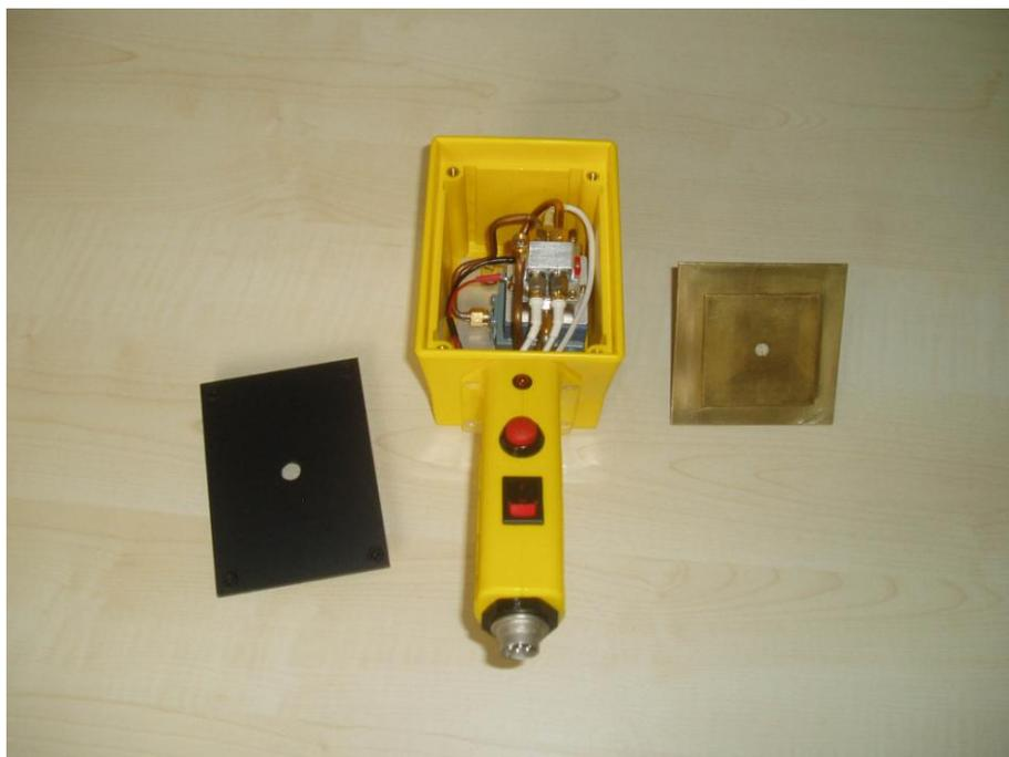
Foto 4. Contenitore con impugnatura e antenna a patch.
