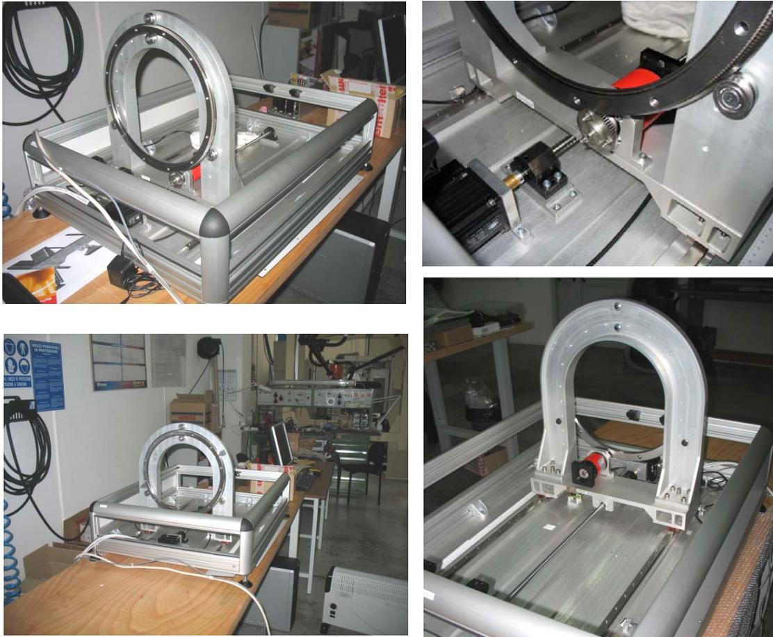
**Figura 6 - Fase di assemblaggio e verifica dell'arco (gantry) e dell'asse circolare C.**
