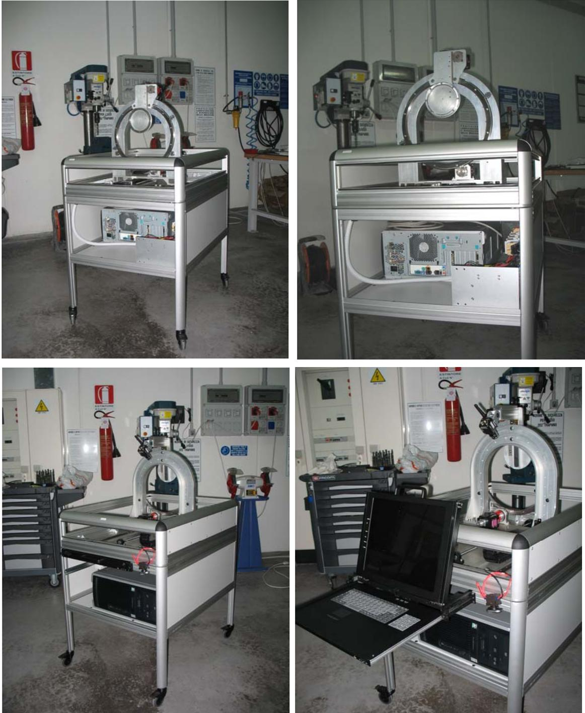
**Figura 8 - Immagini della fase di assemblaggio e verifica di carrello e base macchina.**
