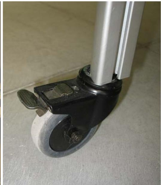
**Figura 13 - A sinistra la macchina SATIS carrellata e con maniglie di manovra. A destra un dettaglio delle ruote antistatiche dotate di sistema di stazionamento.**
