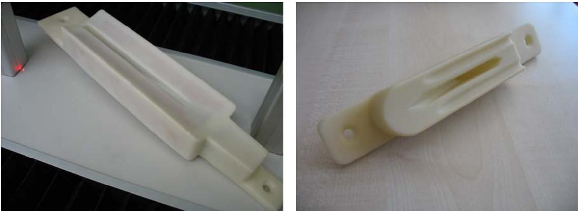
**Figura 34 - Prototipi dei lettini intercambiabili realizzati mediante prototipazione rapida STL. Misura per ratti giovani e adulti (a sinistra) e per topi (a destra).**
