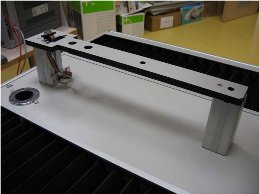
**Figura 36 - Supporto e sistema di ancoraggio modulare per lettini di diversa misura (topi, ratti giovani, ratti adulti, conigli).**
