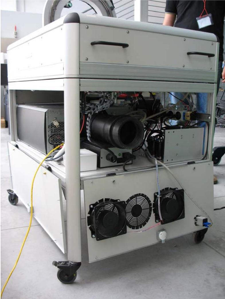
**Figura 32 - Accessibilità agli apparati elettrici ed elettronici di SATIS.**
