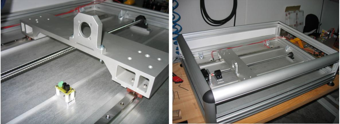
**Figura 4 - Asse X completo di slitta montato e verificato nella geometria.**
