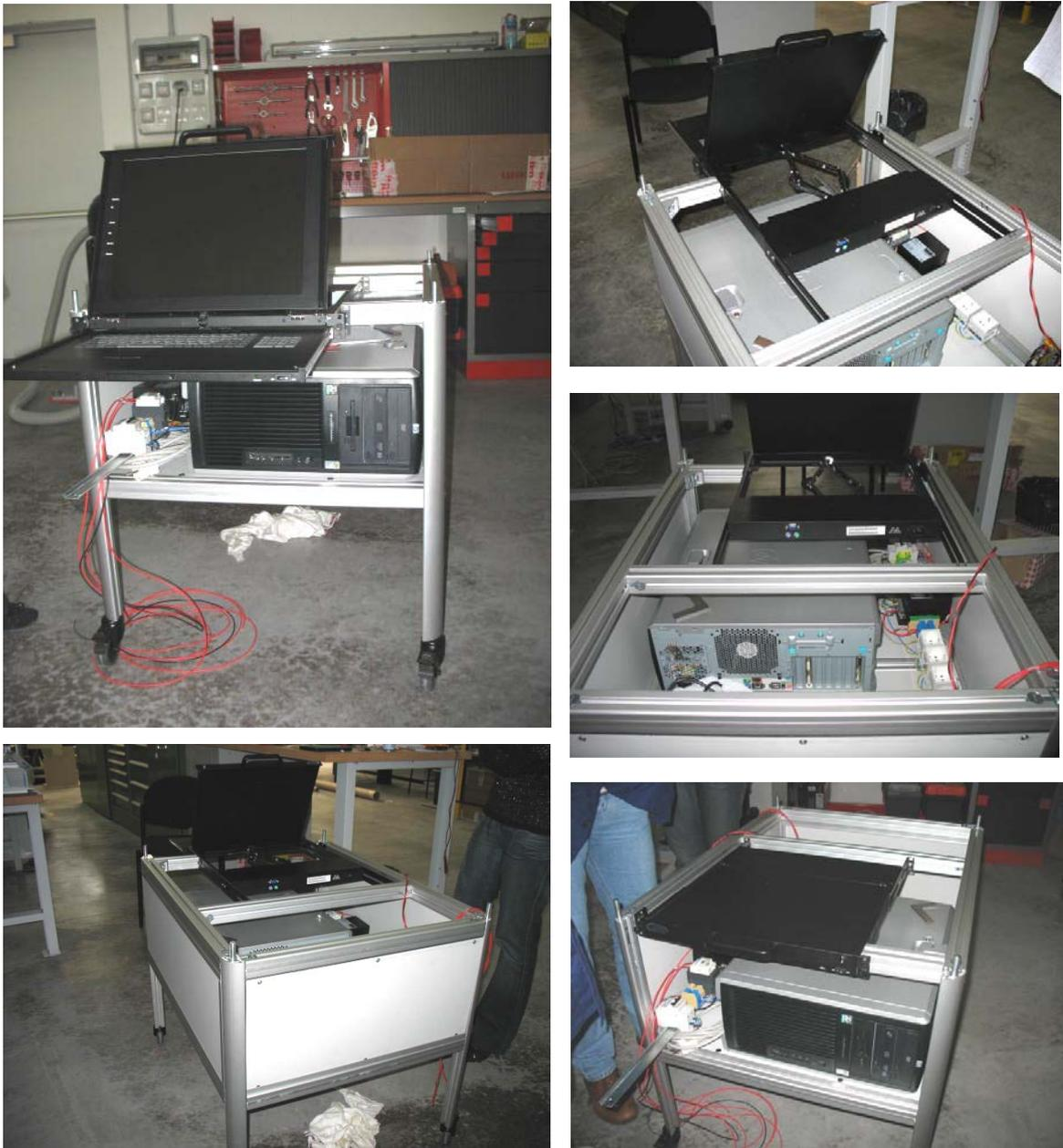
**Figura 7 - Immagini della fase di assemblaggio e verifica carrello macchina ed apparecchiature elettriche ed elettroniche.**
