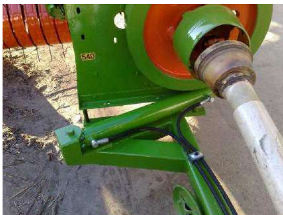
Esempio di albero cardanico non adeguatamente protetto
