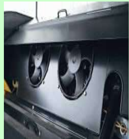
Esempio di ventilatori nel sistema di legatura
