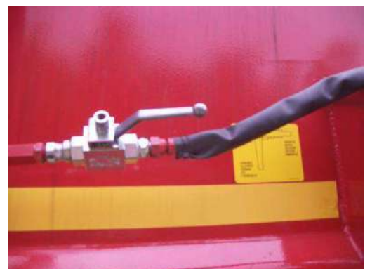
Esempio di dispositivo di bloccaggio idraulico ad azionamento manuale
