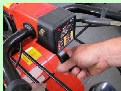
Esempio di dispositivo di bloccaggio delle stegole
