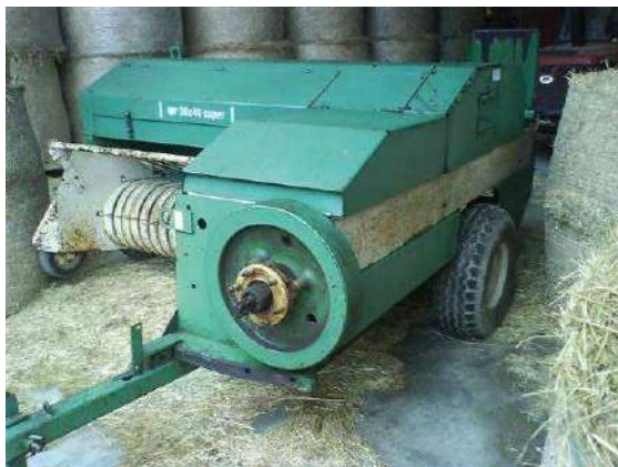
Esempio di imballatrice prismatica priva di protezioni adeguate
