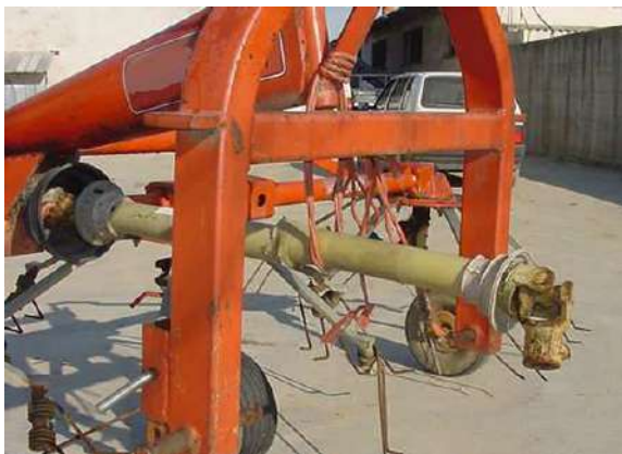
Esempio di trasmissione cardanica non adeguatamente protetta
