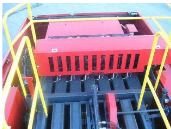
Esempio di mancorrenti
