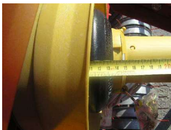
Esempio di protezione del collegamento al cardano
