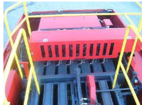
Esempio di mancorrenti
