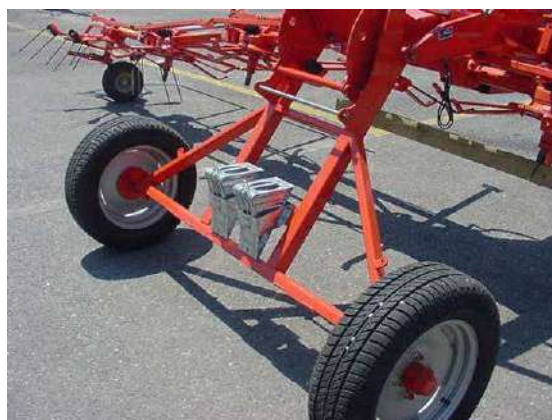
Esempio di spandivoltafieno con cunei di blocco alloggiati sulla macchina
