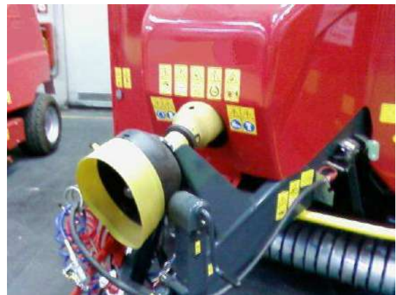
Esempio di trasmissione cardanica protetta
