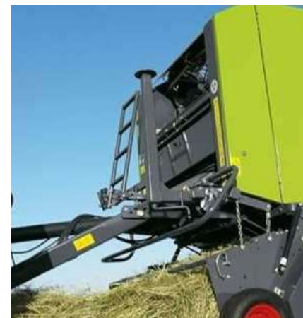
Esempio di scaletta di accesso
