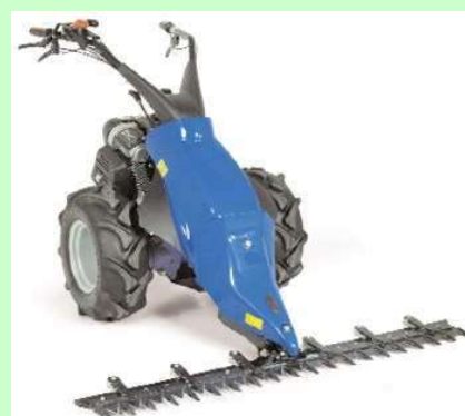
Esempio di motofalciatrice con distanza corretta tra stegole e barra falciante
