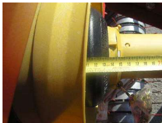
Quota minima di sovrapposizione (UNI EN ISO 4254-1)
