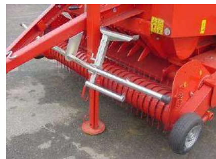
Esempio di scaletta di accesso
