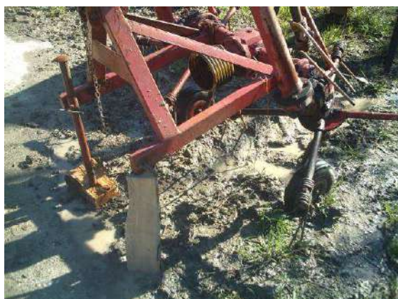
Esempio di spandivoltafieno dispositivo di supporto rudimentale
