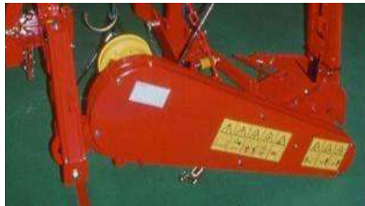
Esempio di riparo chiuso mediante bulloni
