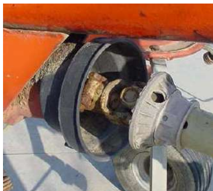
Esempio di trasmissione cardanica non adeguatamente protetta
