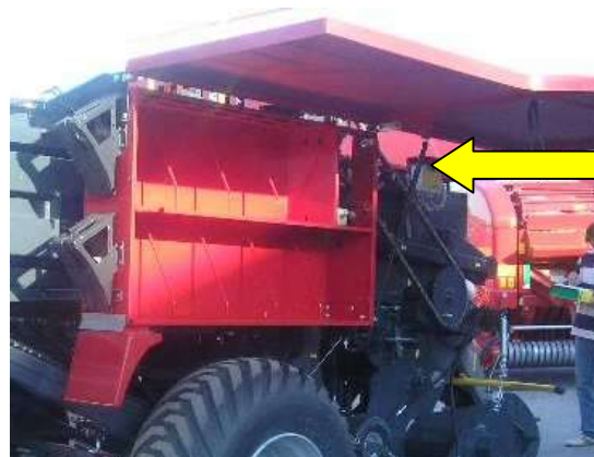
Esempio di martinetto idraulico per elementi sollevabili
