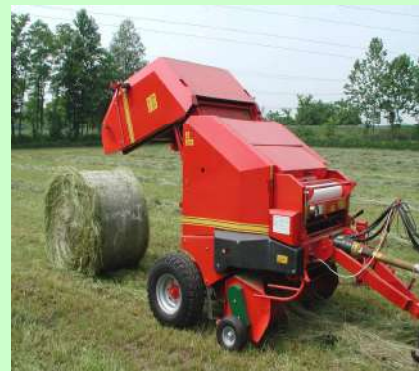
Esempio di espulsore della balla adeguatamente protetto
