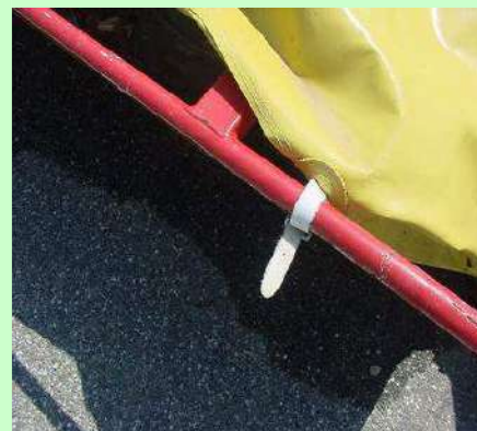
Esempio di fissaggio del telo mediante tubolare
