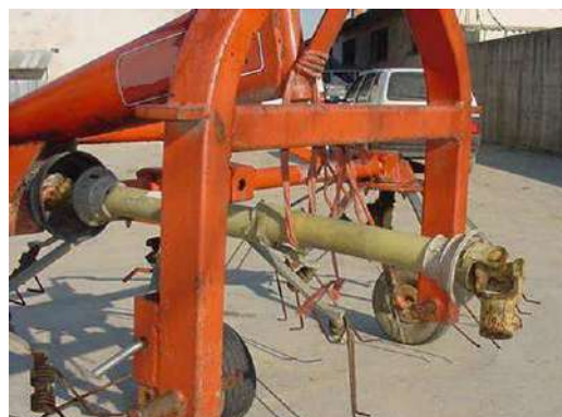
Esempio di trasmissione cardanica con protezioni insufficienti
