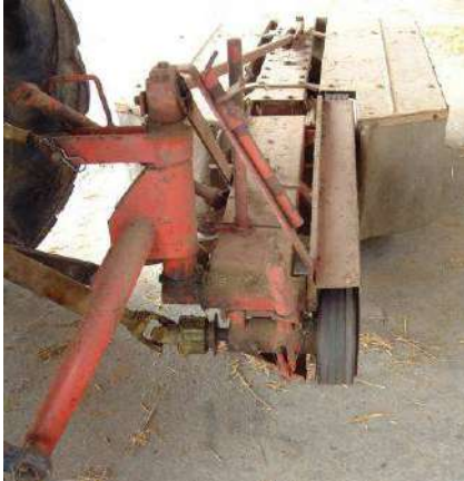
Esempio di organi di trasmissione non protetti
