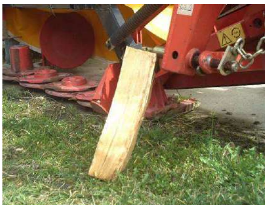
Esempio di falciatrice con sistema di appoggio rudimentale
