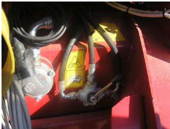
Esempio di circuito idraulico privo di protezioni contro il rischio di proiezione di fluido
