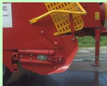
Esempio di protezione laterale del pick-up
