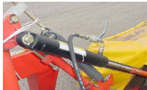
Esempio di dispositivo di blocco idraulico
