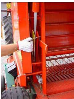
Esempio di supporto meccanico per operazioni di manutenzione
