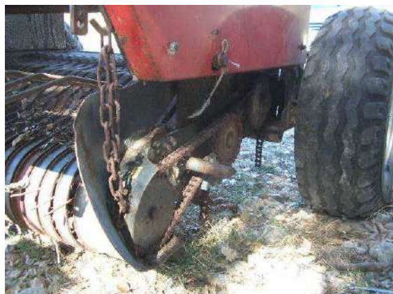
Esempio di catena di trasmissione priva di protezioni
