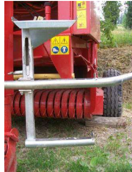
Esempio di scaletta di accesso
