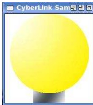
Figura 5.7: Accensione lampada UPnP alla pressione del tasto della pulsantiera Konnex.
