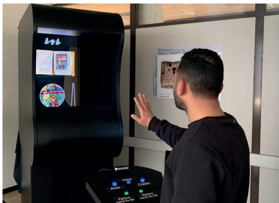
Figura 9. Vetrina olografica dedicata al manoscritto, l'interazione è gestita attraverso una pulsantiera e i movimenti della mano che vengono tracciati da un sensore di cattura del movimento
