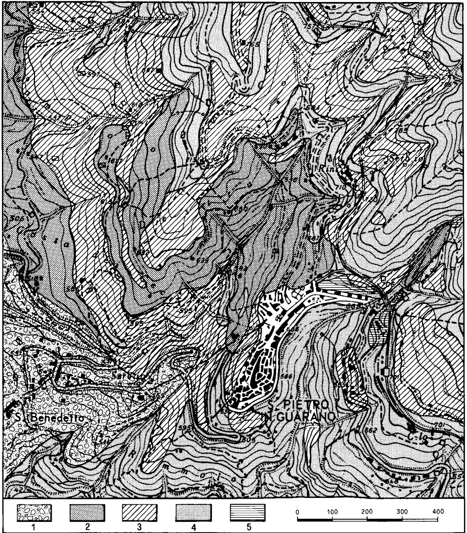
Fig. 10 - Stralcio della carta del grado di alterazione degli gneiss di S. Pietro in Guarano 1 - Terreni sedimentari del Pleistocene; 2 - Terreni residuali e colluviali (classe VI); 3 - Gneiss completamente alterato «saprolite» (classe V); 4 - Gneiss altamente alterato (classe IV); 5 - Gneiss moderatamente alterato (classe III).
