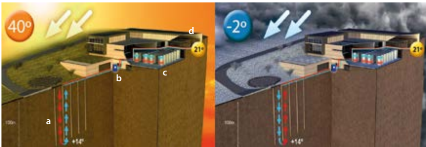
Figura 3. Funzionamento dell'impianto geotermico spagnolo a seconda della stagione (estate a sinistra, inverno a destra). Si notino: (a) le sonde geotermiche, (b) la pompa di calore, (c) i tini, (d) la stanza per l'invecchiamento.
